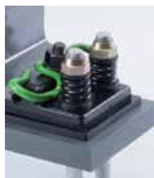
3. és 4. kép (forrás: Vossloh) A Vossloh 336-os rendszer egy nagy rugalmasságú sínleerősítés a zúzottkő nélküli beton- és acélkonstrukciókhoz. Ezt a pontszerű leerősítési megoldást kétsavasos (bal o.) és szűk ívekben négycsavasos (jobb o.) változatként építették be
