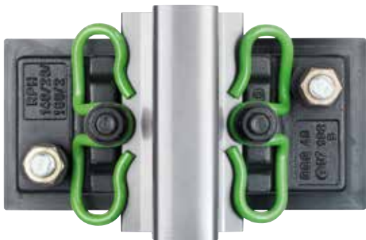
3. és 4. kép (forrás: Vossloh) A Vossloh 336-os rendszer egy nagy rugalmasságú sínleerősítés a zúzottkő nélküli beton- és acélkonstrukciókhoz. Ezt a pontszerű leerősítési megoldást kétsavasos (bal o.) és szűk ívekben négycsavasos (jobb o.) változatként építették be
